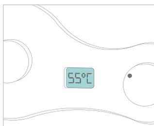
Iono Select i D y Top Sealed i D incorporan un display digital de temperatura que informa en todo momento de la temperatura de salida del agua. Para seleccionar otra temperatura sólo se debe ajustar el mando selector de la misma. Así el usuario podrá elegir la temperatura de ACS que mejor se adapte a sus necesidades.
