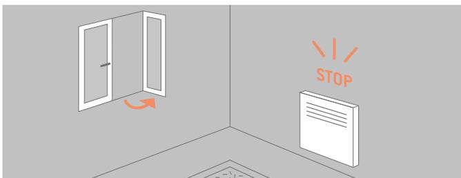
La función apertura de ventanas o ventilación automática detecta la apertura y cierre de las ventanas.
